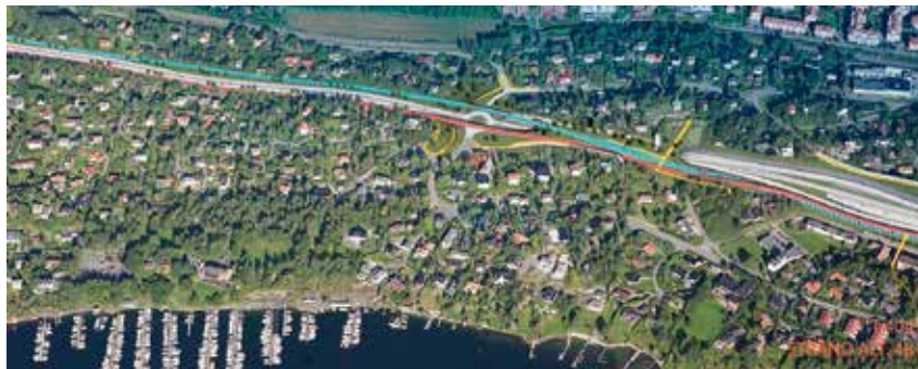
Alternativ 4B hvor Bærumsdiagonalen kobles på ny E18 inni tunnel og dermed ikke blir synlig i terrenget ved Strand.
